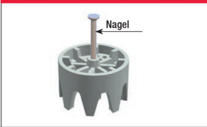
Justierbarer Schalungsanschlag aus Kunststoff mit eingestecktem Nagel zum Justieren der Schalung im unteren Bereich, zum Annageln bzw. Anschließen. Wird mit bereits eingestecktem Nagel ausgeliefert.
